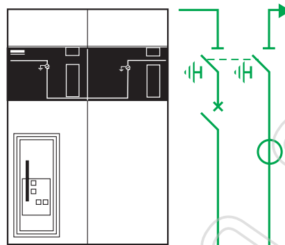
Disjuntor duplo seccionamento com transição à direita ou à esquerda por barras DM2 (1500 mm)
