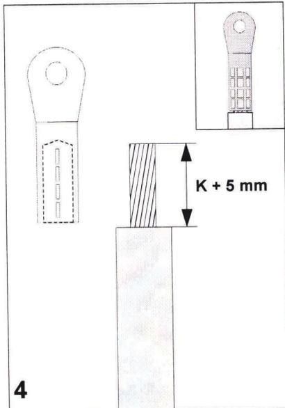
Corte a isolação de acordo com a dimensão **K** (**K = Profundidade do Barril + 5 mm**).
