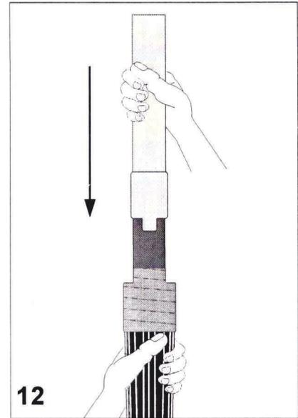
Empurre a terminação de uma só vez, desde o topo da isolamento até o corte da capa externa.
