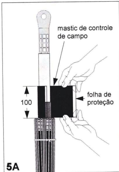
Retire uma das folhas de proteção do Mastic de controle de campo (**Verde ou preto**) e o aplique alinhado com o corte da camada semi-condutora. Enrole-o sobre o cabo como mostrado na fig. 5, removendo a outra folha de proteção.
