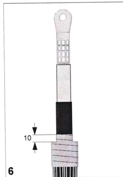
Começando 10 mm acima dos fios da blindagem, enrole uma camada do selante vermelho (Mastic Vermelho), com uma pequena sobreposição e uma leve tensão sobre os fios da blindagem do cabo e do selante previamente aplicado.
