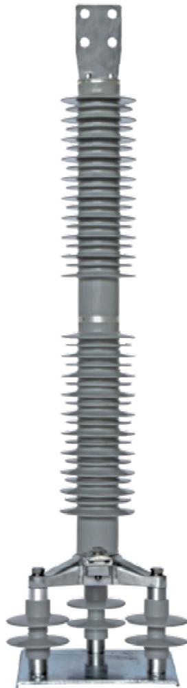
Os para-raios tipo estação Balestro foram desenhados para excelente performance na proteção contra sobretensões em instalações industriais e subestações, tanto internas quanto ao tempo, oferecendo características de proteção otimizadas, grande resistência mecânica e elevada resistência a intempéries, com seu invólucro em borracha de silicone e um sistema de vedação da parte ativa que impede a penetração de umidade, mesmo em condições extremas de poluição e intempérie.
