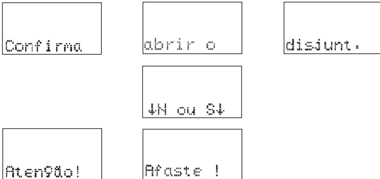
Figura 3.12: Comando local para abrir o disjuntor.
